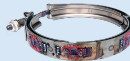
DMS-Applikation an Spannschelle
